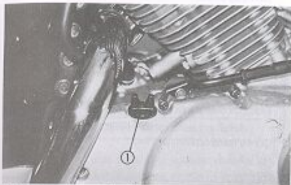
1. Tampa de enchimento de óleo
